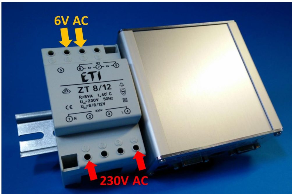
Abbildung 2: Messgerät mit Hutschiene montage mit Markierung der anzuschließenden Klemmen
